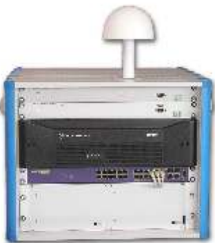
Stazione Ripetitrice Satellite con network interface, switch e SATSync
