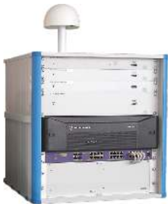
Stazione Ripetitrice Master con Traffic Manager, network interface, switch e SATSync.
